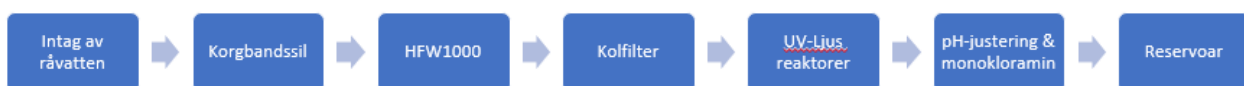
Figur 2. Blockschema över alternativ process med nanofilter för produktion av dricksvatten vid Görvälnverket.
